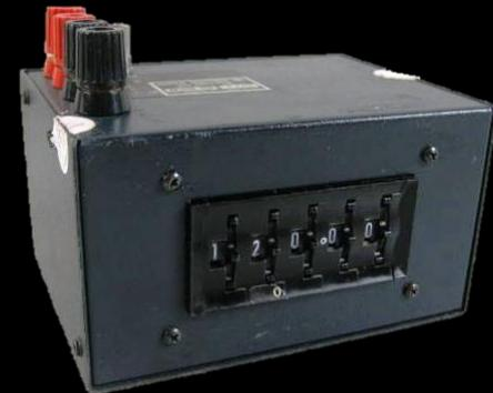
Equipo para simular Resistencia de RTD's
